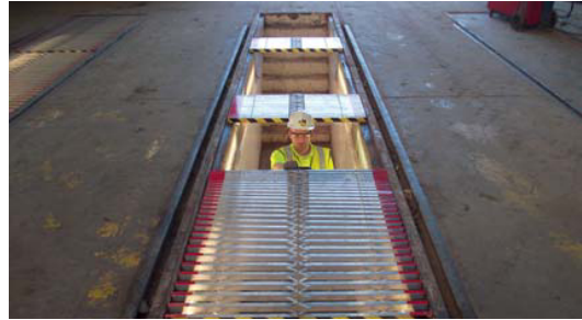
Sicher arbeiten an und in der Grube: Bei PitProtect von Kee Safety handelt es sich um eine ausziehbare Abdeckung, die speziell ausgelegt ist für den Einsatz in Pkw- und Lkw-Werkstätten, wo viele Routinearbeiten in Fahrzeuggruben ausgeführt werden.
